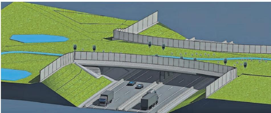
Das 27 Meter breite Betonasphaltband der A 49 durchschneidet den Dannenröder Forst, der vielen Tieren und Pflanzen Raum bietet. Deshalb wird eine Grünbrücke mit Irritationsschutzwänden bei vier Kammolch-Teichen in
